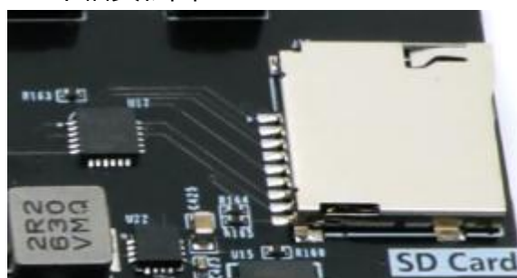
图 12-2 SD 卡槽实物图
