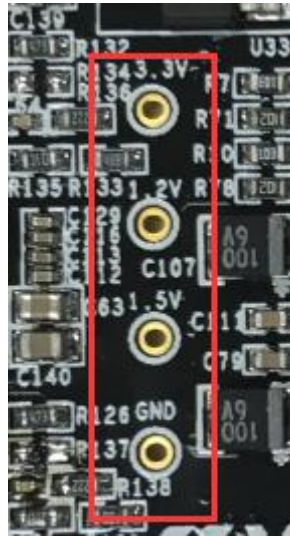
图 2.2 实物图中的电源测试点
